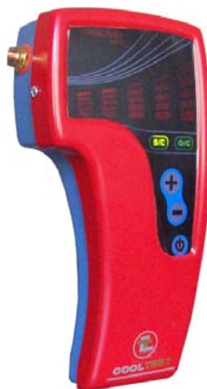
VALTEST 371 ANALIZADOR DE VALVULAS PARA COMPRESORES DE REGULACION EXTERNA
